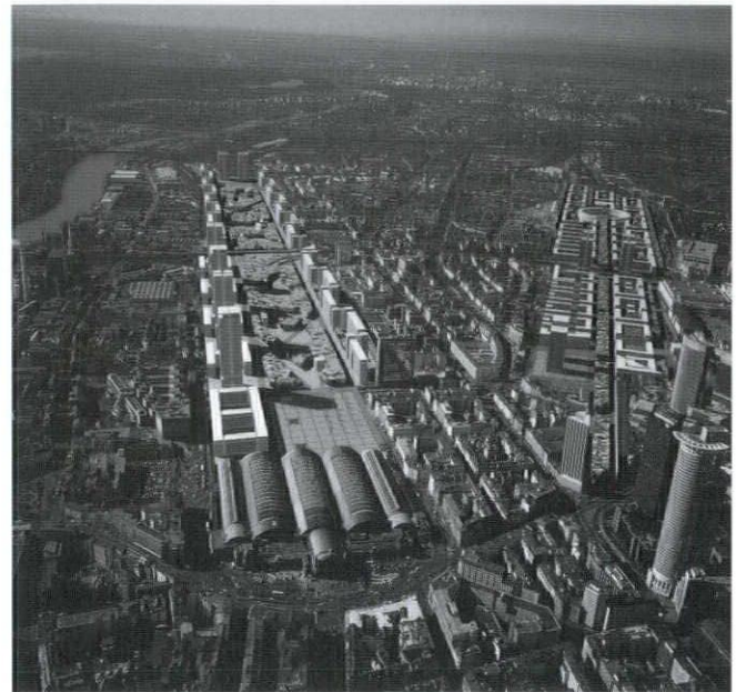
改造後のフランクフルト中央駅付近のCG モンタージュ。既存の駅アーチを残し、軌道を地下化する ことで、地上部を建物とオープンスペースに転換する。貨物用の駅を撤去して市街地化する 提案
